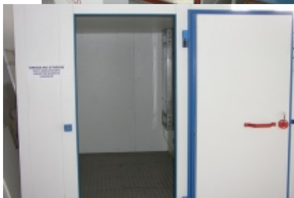
Stanowisko do przeprowadzania prób środowiskowych
